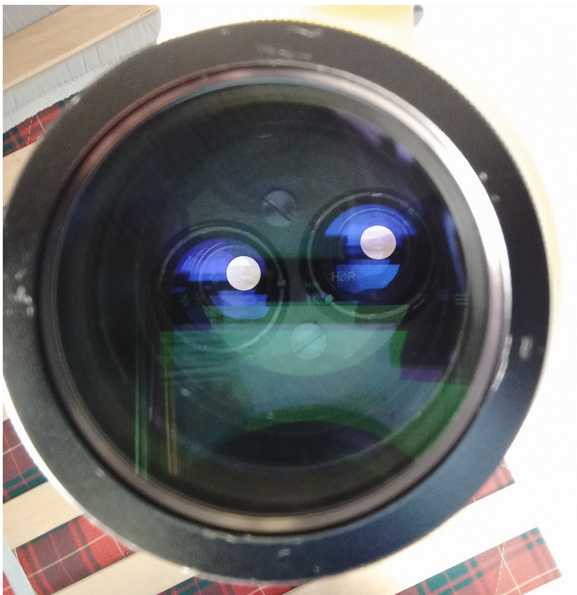
Ajout d'un verre de protection. Plus de danger pour l'objectif, possibilité d'utiliser des percuteurs ou autres outils de préparation avec cette loupe binoculaire.
